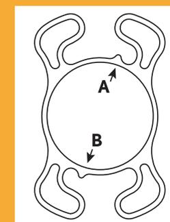
Sobald die IOL implantiert ist sollten sich die Orientierungen an der Optik-Außenkante oben rechts (A) und unten links (B) befinden.
